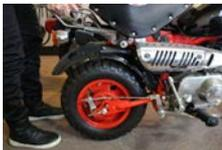
2.リアショックをシャフトから抜きます。外側へリアショックを引き抜くと簡単に外れます。この時1人がリアキャリアを支えて、車体後方が沈み込まないようにしてください。内側のワッシャーはそのままシャフトへ取り付けした状態にします。
