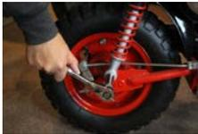
1.リアショックを車体から取り外します。上下共にレンチ14mmを使用して袋ナットを取り外します。ワッシャーは再利用します。ワッシャーは上側のシャフトがショック両側各1枚、下側は外側のみ1枚です。上側はワッシャーサイズが大きく、下側は小さいです。
