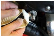
3.リアショックの上下を確認した上で新しいリアショックエンドアイをシャフトへ差し込みます。この時、シャフトへモリブデングリスを塗布してください。通常、スプリングピッチが細かい方が上側となります。
