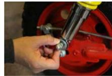
4.リアショックを取り付けた後、外側のワッシャーを取り付けし、袋ナットを締め込んでください。適正トルクは2.5~3.5kg/mです。
