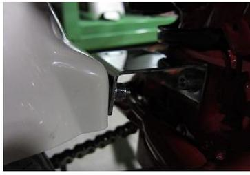
前方ステーをフレームのフェンダー穴(2か所)へキャップボルトM6×15・・・2ヶ、ワッシャーM6(大サイズ)・・・2ヶを使い取り付けします。
