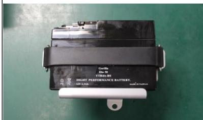
④.バッテリーを装着する際は、スポンジシートの厚みでスムーズに入らない場合があります。その場合は、シリコンスプレーをバッテリーの左右側面に吹きかけただければ、スムーズにバッテリー取り付けが可能です。
