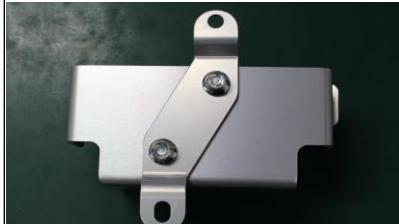
①.アルミ製バッテリーケースメインケースとアルミ製ステーを画像のように合わせ、取り付けます。ステーには二カ所の穴があり、バカ穴の方を下にしてください。取り付けには極低ボルトM6×15mm(表側に使用)、フランジUナットM6(裏側に使用)を使用します。バッテリーケース裏面の画像です。
