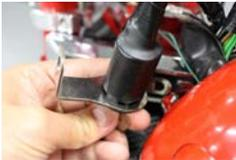
3.キーシリンダーをステーへ取り付けします。カチッと音がするまで差し込んでください。次にキーシリンダーの配線をメインハーネスへ再び差し込みます。
