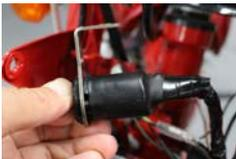
4.画像のように収縮チューブを用いキーシリンダーへ防水処理を施すこともお勧めです。もしくは簡易的にビニールテープでも対応できます。雨水が掛からない様、対策を施してください。
