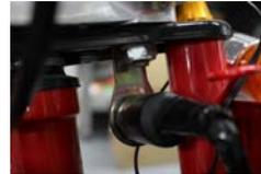
5.ステム裏からブラケットのボルトM10に共締めします。純正フランジ付きナットを再利用します。キーシリンダーはボルトを締め付けする際に動かぬよう、ボルトを締めてください。ステーはハンドルを旋回させた際に干渉しない位置に固定します。
