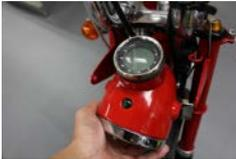
2.ヘッドライトをフロントフォークから外します。作業効率がアップします。その後、ハンドルブラケットのナットM10を17mmのスパナで緩めてください。キーシリンダーはステム左側へ取り付けします。右はホーン台座があり取り付けできません。
