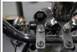
4.キーシリンダーはボルトを締め付けする際に動かぬよう、ボルトを締めてください。スイッチの配線がハンドル旋回時に他部品と干渉しないことを確認してください。
