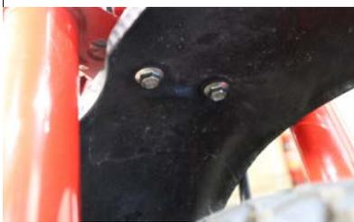
③.ボルトを10mmソケットレンチで締め上げます。しっかりと固定してください。ステーはバカ穴ですので、左右のバランスを均一にしながら固定してください。モンキーの場合は純正フォークの場合、バカ穴の前方寄りの位置で固定します。
