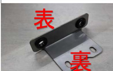
①.グロメットを取り付けます。グロメットに刻まれたミニモトの文字が表面にくるように取り付けしてください。グロメットが入りにくい場合はお湯につけて、柔らかくなってから再び取り付けします。取り付けの際、ステーのエッジ部で指先をケガしないように注意してください。
