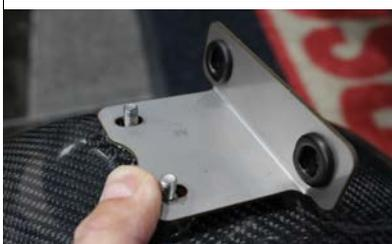
②.ステーとフェンダーの穴位置を揃え、純正部品の段付きボルトM6を使って仮組をします。純正部品の段付きボルトM6をフェンダーグロメットに差し込みます。この際、市販のボルト等を使うと樹脂フェンダーが割れることがありますので、ご注意ください。
