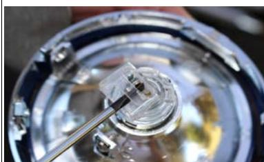
①.先端が細気味のマイナスドライバーで3極端子メスカプラーソケットAssyの中央端子と上から見て右側の端子の爪を若干右側に向けるように曲げます。一旦コネクターカプラーと合わせ、それでも爪が曲がっている場合にはもう一度修正を行ってください。修正完了後、コネクターを接続してください。
