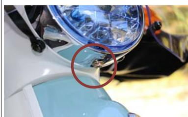
②.夜間走行時に光軸方向が気になる場合はリム下側のネジを緩め、レンズを指先で軽く押していただくと向きが変わります。調整完了後、ネジは締め付けてください。
