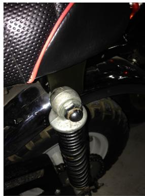
2.純正リアキャリアとローダウンタックロールシートの同時装着はできません。純正リアキャリアのM12ボルトを外し、リアキャリアを外してください。リアショックの純正ロングボルトを外し、付属のロングボルト250mmを装着します。右2番目の画像のように、リアショック内側にM10ワッシャー大を入れるとよりしっかりと取り付けできます。このワッシャーは付属していません。
