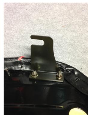
1.シートをひっくり返し、前方のボルト穴へカラーM6×t4をシート鉄板とステーの間に入れ、フランジキャップボルトM6×20で取り付けします。ステーの向きに注意してください。湾曲している側をシート後ろ側に向けます。後ろ側ステーは六角フランジ付きナットで取り付けします。前後ステーには長穴加工を施しております。フレームへ装着の際に微調整を行い、完璧な位置にシートをセットしましょう！
