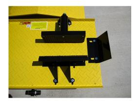
フロントホイールストッパーを取り付けします。まずは正面ストッパーを画像のように取り付けします。次にホイールバイスの左右クランプを画像のように取り付けします。使用するタイヤサイズによって自由に長穴の中で調整できます。ストッパー、クランプは六角ボルト>クランプ・ストッパー>ワッシャー> 六角ナットの順に取り付けします。増締めも確実に行います。
