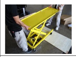
木箱からリフトを取り出します。取り出しの際、ジャッキアップの油圧フットペダルを手(軍手をはめてください)で数回圧縮させ、作業台を30cmほど持ち上がるようにします。作業台が木箱の高さよりも高い位置になったら、2人で作業台を持ち上げ、箱の外へ運び出します。大人2人であれば、運び出せますが、決して軽くはありませんので、落下や指詰めには十分に注意して、慎重に作業を行ってください。
