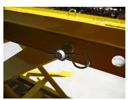
ジャッキアップペダル作動接続シャフトのリターンスプリングのテンションを調整します。六角ボルトの向きが時計の4~5時の位置で固定します。六角ボルトは確実に固定してください。この調整がリフトダウン時のスムーズな動作へ影響します。調整が不十分な場合、作業台が想定外のリフトダウンをしてしまうことがあり、大変危険です。この作業を行う前に付属品の安全リフトダウン防止棒を使用してください!\*調整中に作業台が下がることを防止します。
