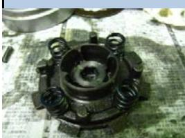
4.ここから組み付けが始まります。20%パネレートアップクラッチスプリング(4本)をクラッチハウジングに載せます。
