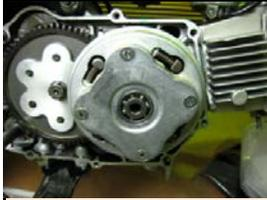
10.アウターカバーガスケットとアウターカバーを取り付けします。
