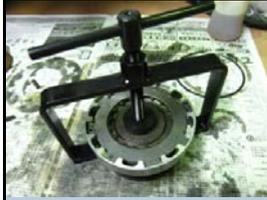
1.クラッチスプリング圧縮工具もしくはバイスを使い、スプリングを圧縮させます。
