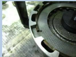
6.セツリングをクラッチハウジングの凹みに合わせてセットします。
