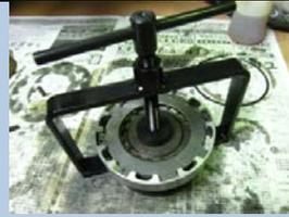
5.外した際の逆の手順でクラッチハウジングに部品を載せます。
