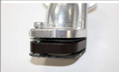
③マニーホールド→ガスケット→フェノール樹脂製インシュレーター→ガスケット→シリンダーヘッドの組み合わせで取付けします。
