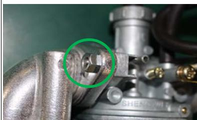
②付属の六角ナットM6でマニーホールドとキャブレター本体を合体させます。1.0kg・mのトルクで締め付けてください。
