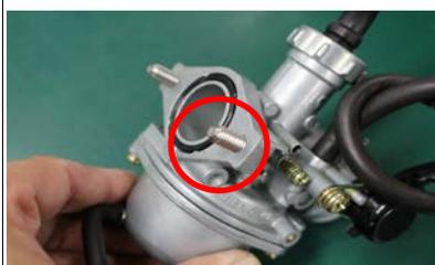
①付属のズンギリボルトM6×22(mm)を使いボルト穴へズンギリボルトを取り付けします。その際、ねじ緩み止め材をご使用いただくことをお薦めします。ネジの噛み合わせがしっかりかみ合わさることを確認してください。
