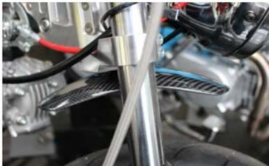
2.フェンダーの取り付け穴、フロントフォーク・トリプルツリー裏面のフェンダー穴と位置合わせを行います。
