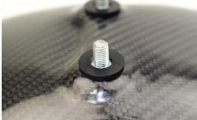
1.フェンダー取り付け穴(2か所)に付属のカーボンフェンダー専用グロメットφ6を取り付けします。
