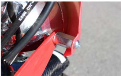
1.純正ヘッドライトケースレンズボルトM6を2箇所外してヘッドライトケースからレンズを外します。
