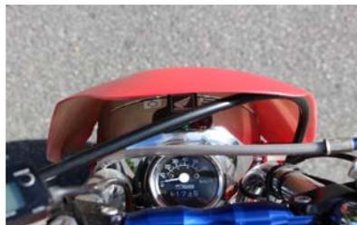
2.カウル本体を軽く外側に引っ張りながら、ステーにかぶせるようにして、カウル本体のネジ穴と特殊高ナットステーのネジ穴の位置を合わせてください。純正ボルトM8を使用してカウル外側から固定してください。
