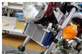
オイルクーラー本体を分解し、ステーを組換えした状態で取り付けした場合です。コンパクトに取り付けできる理想的な取り付けパターンです。ステーは縦長穴が空いています。適切な位置でステーを固定します。
