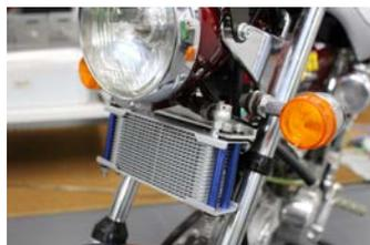
お届け状態のオイルクーラーステー組み付けパターンで、ステンレス製ステーへ取り付けした場合です。もっとも手軽な取り付け方法ですが、車体によってはフルストローク時にフェンダーとオイルクーラーが干渉することがあります。ステーは縦長穴が空いています。適切な位置でステーを固定します。
