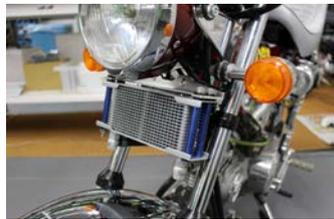
オイルクーラー本体をひっくり返し、フィッティングを下向きに取り付けした場合です。この場合はフルストローク時、フェンダーとフィッティングが干渉しないことを確認してください。ステーは縦長穴が空いています。適切な位置でステーを固定します。
