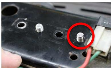
②4Lモンキーの場合、写真の赤マークの位置に穴空けします。市販の電動ドリルでM6穴を空けてください。空ける位置は既存の3ヶ穴と同軸、同ピッチで穴空けを行います。
