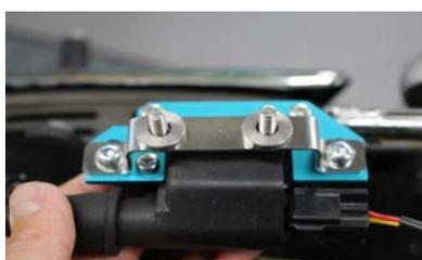
①SPII汎用ハイパワーコイルとウオタニパッケージ入り付属ステーを組み立てます。ステンレス製ステーは写真のようにボタンボルトM6×15 2ヶと六角フランジUナットM6 2ヶを使い組み付けます。付属スペーサー厚さ4mmは写真のように取り付けします。\*写真のSPII汎用ハイパワーコイルはステッカーを剥がした製品を使用しています。
