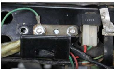
③純正部品のコネクターガイドパネルを元に戻し、付属の六角ナットM6 2ヶ、平ワッシャーM6 2ヶ、スプリングワッシャーM6 2ヶを使用してSPII汎用ハイパワーコイルを固定します。緑色電線はアースのためボルトに共締めします。
