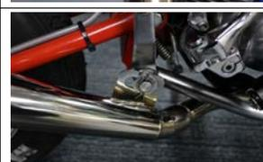
②サイレンサー部の長穴をブレーキペダルピボットシャフトへ引っかけ、付属のブレーキペダルピボット平ワッシャーとスナップピンφ14で固定します。シリンダーヘッドナットを増し締めします。
