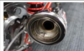
③付属のエアバツフルをキャップボルトM6×8で取付けします。エアバツフルは指先で穴位置を合わせキャップボルトを指先で回るとことまで回し、次に六角レンチで増し締め、固定します。
