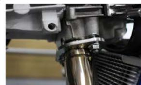
①シリンダーヘッドへ付属のマフラーガスケットを取り付けします。次にスタッドボルトへマフラーフランジボルト穴を合わせ、付属六角ナットM6で固定します（仮止めとしてください）。
