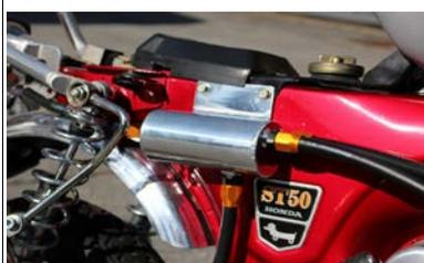
②純正ボルトをご使用いただき、画像のようにステーをフレームへ固定します。
