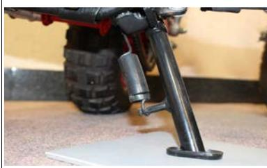
スプリングはストレート状態を上とし、R状態を下に向け、画像のように取り付けします。
