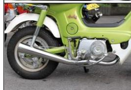
⑤マフラーはこのように取り付けられます。ブレーキペダルはマフラーと干渉するため、マフラー交換後は必ず、ブレーキペダルの踏み込みストローク量を点検します。ストローク量は約30mm前後がおすすめです。
