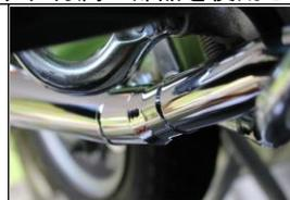
④キックペダルとエキゾーストパイプのクリアランスは極わずかです。キックペダルは可倒式の場合、ペダル踏込時にエキゾーストパイプと干渉することがありますのでご注意ください。
