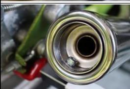
③付属のエアバツフルをキャップボルトM6×8で取付けします。エアバツフルは指先で穴位置を合わせキャップボルトを指先で回るとことまで回し、次に六角レンチで増し締め、固定します。
