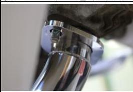
①シリンダーヘッドへ付属のマフラーガスケットを取り付けます。次にスタッドボルトへマフラーフランジボルト穴を合わせ、付属六角UナットM6で固定します（手順②の後、本締めを行います）。
