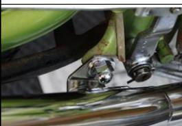
②サイレンサー固定穴をフレーム側の純正サイレンサー固定マフラー穴と合わせ、裏面からキャップボルトM10、平ワッシャーM10、表から平ワッシャークローム、袋ナットM10で固定します。
