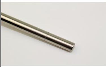
ステック先端から18mmの位置にオイルレベルラインがあります。この線を目安にオイルを入れてください。オイル量を確認する際はウエスでステックに付着したオイルを拭き取り、ネジ込まない状態でオイル量を計測します。
