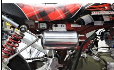
シートステー取り付け穴、マフラステー取り付け穴の2箇所の穴を利用して取り付けを行います。取り付けポジションはシート右側です。
