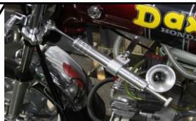
③ハンドルを目いっぱい左へ舵を切った際にダイヤルノブと本体の間に5mmほどクリアランスが残るようにステアリングダンパークランプの位置調整を行います。
