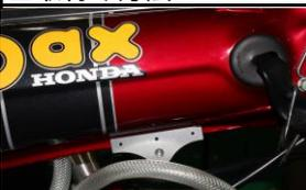
①フレームへアルミ製フレームブラケットを固定します。
