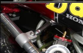
②ステンレス製六角支柱L50mmに平ワッシャーM8、スプリングワッシャーM8を取り付けアルミ製フレーム側メインブラケットに取り付けます。ステアリングダンパークランプ側にも平ワッシャーM8、スプリングワッシャーM8を取り付けます。
