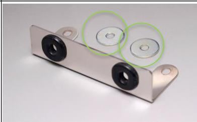
③付属ステーを純正フェンダーステーの前方側の2ヶへ純正M6ボルトを再使用して共締めします。純正ステーの厚み分を調整するため、フェンダーステーの後ろ側には付属のM6平ワッシャー(大)を挟んで取り付けます。
