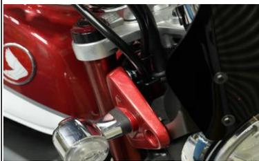
ヘッドライトステーボルトM6×12の4箇所へ付属品の平ワッシャー(大)M6を組み込みます。ヘッドライトステーとワイヤーガイドステーの隙間に取り付けます。
