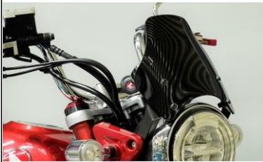
車体への取り付け画像です。カウルステーはヘッドライトステーとヘッドライトの間へ挟むように取り付けます。
