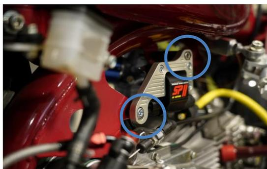
■ステーとSPIIハイパワーコイルを組み付けます。下記の部品を使用します。
