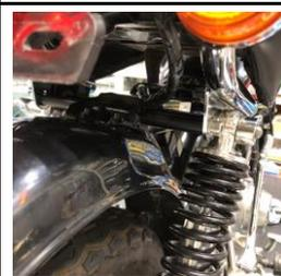
グラブバーを車体に取り付けます。アルミ製カラー内径φ8mm 4ヶ、キャップボルトM8×80 4ヶ、平ワッシャーM8 4ヶ(いずれも付属部品)を使用します。
