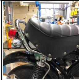
リアショック取り付けの袋ナットM10 4ヶを締め付けして、シート、グラブバーを揺らした際にネジ類の緩みがないことを確認してください。またグラブバーを握り車体を持ち上げてグラブバーがしっかりと固定されたことを確認してください。
