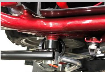
2.グラブバー前方側の取り付けフック(切り欠け)部分を先ほど緩めたリアショックのアッパーマウント部に差し込みます。
