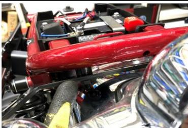
1.純正シートをフレームから取り外します。シート前方のステー左右固定ボルトM8を外してください。シートはゆっくりと後方へ水平に引っ張っていただくとスライドしながら外すことが可能です。
