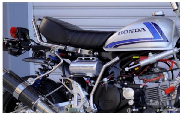
2.グラブバーの切り欠け部分を先ほど緩めたリアショックのアッパーマウント部に差し込みます。リアショックアッパー部の純正部品は再使用して、シート後方ステーをフレームにセットします。
