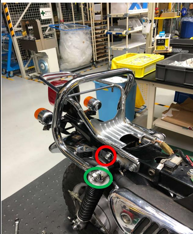
1.フェンダー取り付け純正ボルトM6×25を2本車体から取り付けます。
