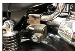
7.ヘルメットホルダーをグラブバー右側へ純正ボルトを使用し、取り付けます。
