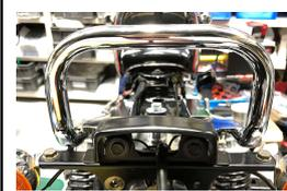
2.グラブバー本体にテールランプマウントを純正ボルトで固定します。電気配線をグラブバーとテールランプマウントで挟まないよう、注意してください。
