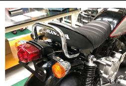
8.グラブバー、テールマウント、各電気配線の接続が完了した後、エンジンを始動して電装系部品が正常に作動するかをご確認ください。また走行前にもう一度、ネジ類の締め付けをお確かめください。
