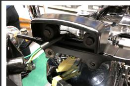
4.テールランプ配線、リアウinker左右配線をグラブバーに空けられた配線ホールにグラブバーの上から下へ通し、グラブバーの裏面へコネクター部を取り回します。
