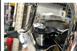
3.付属のアルミ製スペーサーを使用し、付属の六角フランジボルト 6×40mm、平ワッシャーで固定します。
