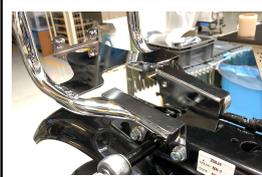
1.グラブバーをフレームに装着します。純正リアキャリア取付ボルト4本を使用します。
