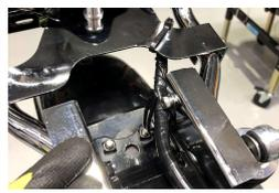
6.ワイヤークリップ、キャップボルトワッシャ組み込み済みを使用し、グラブバー本体に取り付けます。メインハーネスをワイヤークリップで抑えます。配線が遊ぶようであれば、付属のタイラップで固定してください。
