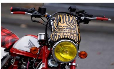
車体への取り付け画像です。バイザーステーはヘッドライトステーとヘッドライトの間へ挟むように取り付けますが、純正フォークはヘッドライトステーの外側へ取り付けしてもかまいません。アルミ製のヘッドライトステーの場合、ステーの厚みがあるため、ヘッドライトステーとヘッドライトの間へ挟むように取り付けします。
