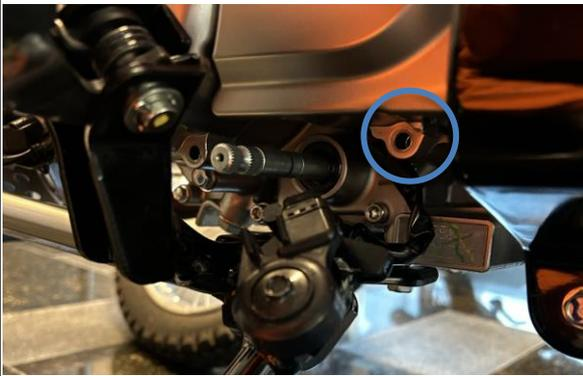
1.ギヤチェンジアームをシフトスピンドルシャフトから取り外します。フットステップ本体を取り付けしているボルト6本を緩め、ステップバーが垂れ下がるような状態にします。
