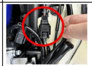
2.カプラーの表面にある爪を押し込み(爪を下げる)、カプラーを引き抜いてください。画像の赤丸部分が車体側ハーネスのオス・カプラー(赤・黒・白電線)です。このカプラーに付属部品のメス・カプラーを差し込み、爪先が引っかかる音がするまで押し込みます。
