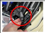
3.付属部品のオス・カプラーを車体側ハーネスのメス・カプラー(灰・空・黒色電線)に差し込みます。 このカプラーに付属部品のオス・カプラーを差し込み、 爪先が引っかかる音がするまで押し込みます。
