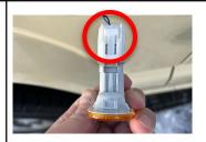
2.純正サイドマーカーとハーネスケーブルのコネク ター部分の爪を外します。
