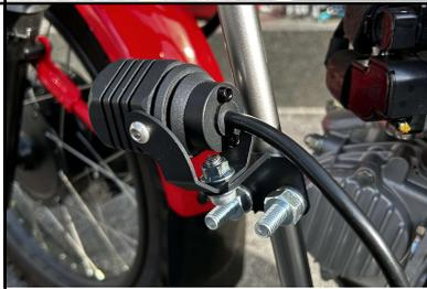
付属のフランジキャップボルトM8×15mm、六角セレートナットM8を使用して、フォグランプ本体Uステーをステーパイプに固定したステーのφ8mm穴へ仮止めします。また走行環境や好みのセッティングに応じてライトの光軸を調整することがあるため後々本締め固定を行います。
