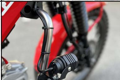
フォグランプ後ろから出ている配線をガードパイプの上方向に向かって、3箇所、等間隔で固定してください。配線は画像のように、パイプの後方に向けてとスムーズな配線取り回しとなり、見栄えがよくなります。
