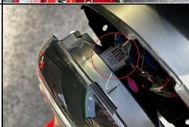
ヘッドライトケースとヘッドライトレンズを止めているナベネジ2本を外し、ヘッドライトレンズを斜め下方向に引きます。赤丸のコネクターの爪を上から抑えながら、コネクターを引き抜くとレンズが外れます。
