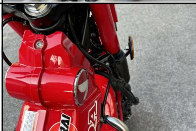
ハンドルを左右に目一杯舵取りをした際、配線が突っ張らない状態でヘッドライト内にフォグランプからの電線を引き込みます。配線が突っ張った状態では走行中に配線が破損する恐れがあります。配線は若干のたわみを持たせた状態にしてください。
