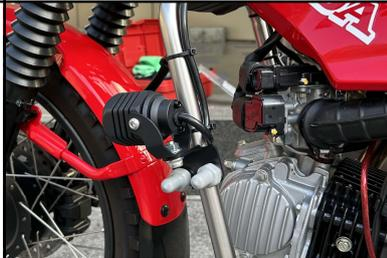
ネジキャップ(カラー:グレー)をライトステー裏側のボルト2箇所(2箇所)に差し込みます。
