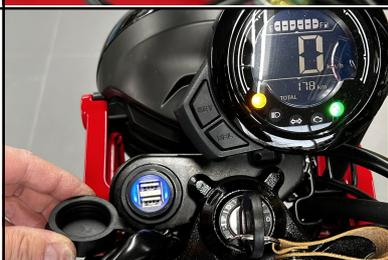
CT125ハンターカブ用アクセサリ電源取り出しコネクタはバッテリー直接供給電源がありません。ACC+電源供給のみとなります(キーを回して通電オンになります)。
