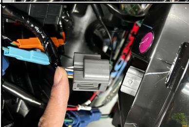
ヘッドライト内の配線作業をやり易くするため、ライトカプラー(灰色)を外します。ヘッドライト上にある爪を軽く押しながら、ヘッドライト全体を作業側面に引くことでコネクタが外れます。
