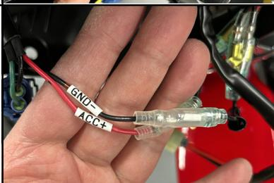
アクセサリ電源取り出しコネクタのACC+電源(配線/赤色)とUSBポートの電線ギボシ(1本接続ギボシ/赤色)を接続します。アクセサリ電源取り出しコネクタのアース(配線/黒色)をUSBポートの電線ギボシ(1本接続ギボシ/黒色)に接続します。
