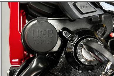
ステムプレートのイグニッションスイッチ左横にあるオプション取り付け用キャップを外します。USBポート本体の樹脂製ナットを外し、オプション取り付け用マウントに差し込み、裏側から樹脂製ナットで固定します。
