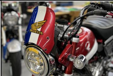
車体への取り付け画像です。バイザーステーはヘッドライトステーとヘッドライトの間へ挟むように取り付けます。
