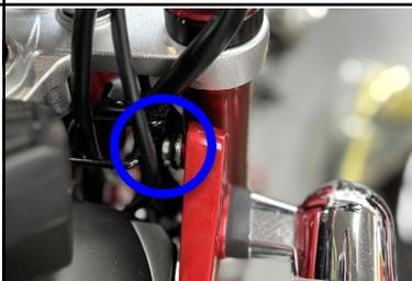
ヘッドライトステーボルトM6×20の4箇所へ付属品の平ワッシャー(大)M6を組み込みます。ヘッドライトステーとワイヤーガイドステーの隙間に取り付けます。
