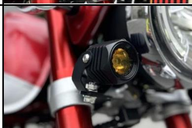
付属のフランジキャップボルトM8×15mm、六角フランジセレートナットM8を使用して、フォグランプ本体Uステーをステーパイプに固定したステーのφ8mm穴へ仮止めします。また走行環境や好みのセッティングに応じてライトの光軸を調整することがあるため後々本締め固定を行います。
