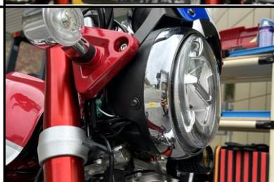
ヘッドライト内部の配線を整え、ヘッドライトレンズを元の通り、ヘッドライトケースに組み込みます。配線はレンズ裏側の凸部分の干渉を回避するよう、ヘッドライトケース内の隙間に上手に戻してください。
