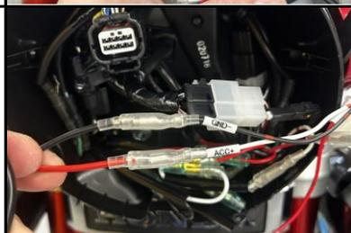
ヘッドライト裏から本体に引き込んだLEDフォグランプキットコンネクターとモンキー125専用ACC電源ハーネスケーブルを接続します。
