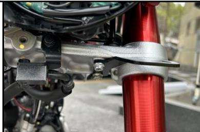
純正フロントフェンダーブラケットを取り外し、トップブリッジ取り付けステーを純正ボルトM6×16を再使用して取り付けます。その際、トップブリッジ取り付けステーと反対側のボルトは平ワッシャー(大)M6を純正フロントフェンダー取り付けブラケットとトップブリッジ取り付けステーの間に入れ、トップブリッジ取り付けステーの厚み分を解消してください。アース電線φ6mmはボルトと共締めしてください。※画像ではダウンフェンダー仕様車のため、純正フェンダー取り付けブラケット仕様とは異なります。
