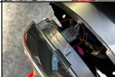
ヘッドライトケースとヘッドライトレンズを止めているフランジナベネジ2本を外し、ヘッドライトレンズを斜め下方向に引きます。赤丸のコンネクターの爪を上から抑えながら、コンネクターを引き抜くとレンズが外れます。
