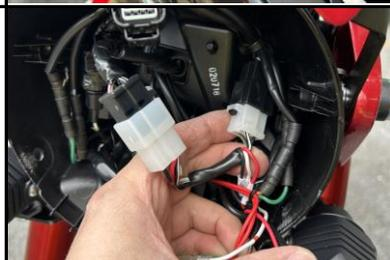
ACC電源用コンネクターのメスカプラーをメインハーネスから抜き取ります(爪を押しながら引き抜きます)。車体側メインハーネスにモンキー125専用ACC電源ハーネスケーブルのカプラーを割り込ませます。オス、メスカプラーをそれぞれを接続してください。
