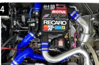
**4** **ハイパーシリコンインタークパイプ3箇所の取り付けが完了**
