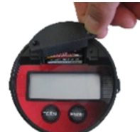
Abbildung 5: Bild 4: Einsetzen des Batteriedeckels, danach Batteriedeckel festschrauben
