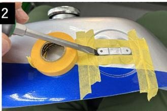
タンクに疵がつかないように、マスキングテープでエンブレムマウント回りを保護します。マイナスドライバーを使用してネジ穴のあるステーを裏側から押し出してください。その際、必要以上にステーを押し出すとステーと燃料タンク本体の溶接部分が剥がれてしまうことがあります。次にエンブレムをエンブレムマウントのネジ穴に合わせてエンブレムの穴とネジ穴の位置が重なるようにしてください。ズれるようであれば、微調整を繰り返してください。
