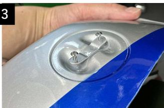
ネジ穴にネジを取り付けます。塗装がネジ穴に入ってしまったため、ドライバー工具を使用してネジが斜めに入らないよう、真っすぐにネジがネジ穴に入るよう、数回ネジを回して、塗装面を壊すように、ネジ穴を整えてください。その後、エンブレムをタンク本体に取り付けしてください。
