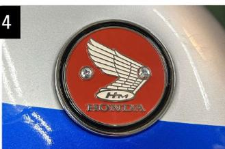
エンブレムがタンクの取り付け面に対して、均一になるよう、エンブレムの位置を整えながらネジを締め込んでください。画像は取り付けイメージです。
