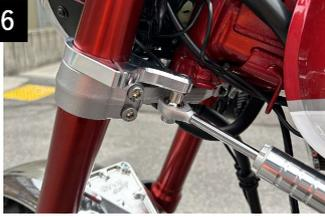
ステアリングダンパー フレーム ステア特殊形状スペーサーφ15×L56mmの取り付け②
