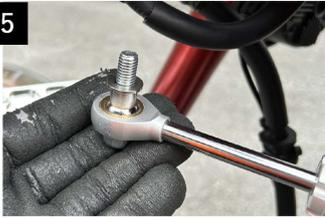
ステアリングダンパー フレーム ステア特殊形状スペーサーφ15×L56mmの取り付け①
