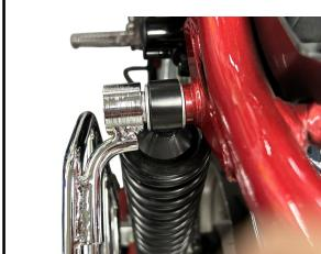
左側のリアショックマウント上側の袋ナット1ヶをソケットレンチを用いて外し純正ます。次のワッシャー2枚を外します。
