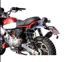
サイドバックステー取り付けイメージです。グラブバーなし、社外製シートの組み合わせです。純正シート、弊社発売のグラブバーとの併用装着も可能です。グラブバーを取り付ける、もしくはグラブバーを取り付けない場合では、付属の平ワッシャー1ヶでステーの厚み分を解消します。
