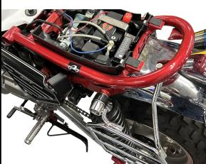
画像のように取り付けされたらサイドバックステーの取り付けは完了です。シートを元の通りフレームに装着してください。
