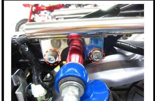
2. M8×20フランジキャップボルト4ヶを使用し、フレームにブラケット本体をマウントします。画像はグラブバー併用のため、グラブバーを使用しない場合は若干取り付け方法が異なります。実際にはブラケット本体をM8×20フランジキャップボルトで取り付けします。
