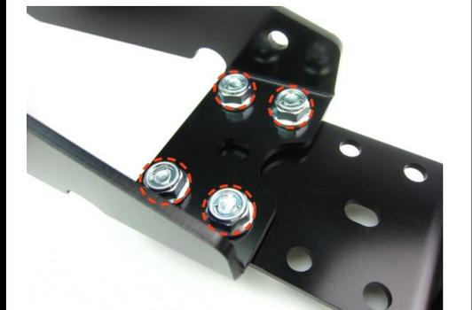
1-A. 本体ブラケットと可動式テールマウントを組み付けます。組み付けにはM6×15フランジキャップボルト4ヶとM6フランジナット4ヶをご使用ください。前後調整は3ポジションで選択が可能です。バイクの仕様に合わせてお好みのボルト穴をご使用ください。
