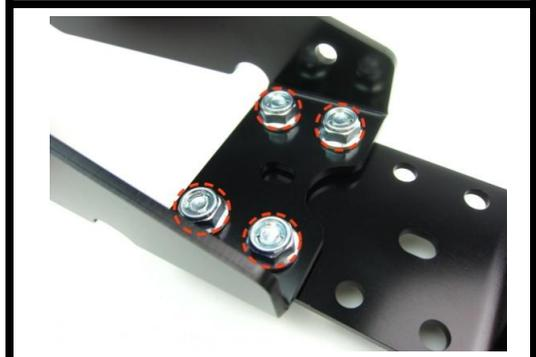
1-B. 本体ブラケットと可動式テールマウントを組み付けます。可動式テールマウント中央部はリアテールランプのマウントゴムを組み込んだ後、ボルト&ナットで組み付けます(図中の青丸)。またテールランプ本体はステー裏側からM6ナット(純正ナットを使用)で固定します。
