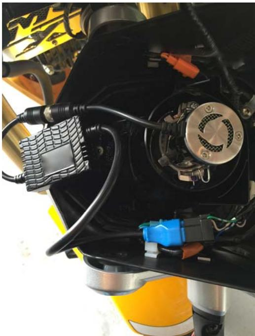
画像のようにLEDを取り付けして完了です。画像ではLED本体の取り付け
