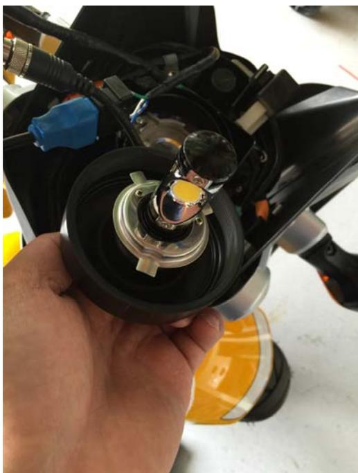
LED本体からソケット金具を取り外し、LED本体にゴムカバーを取り付けます。取り付けカバーとファンから放出される放熱用の通気穴にゴムが被さらないようにします。ゴムカバーが被さることで、熱がこもり加熱する恐れがあ
