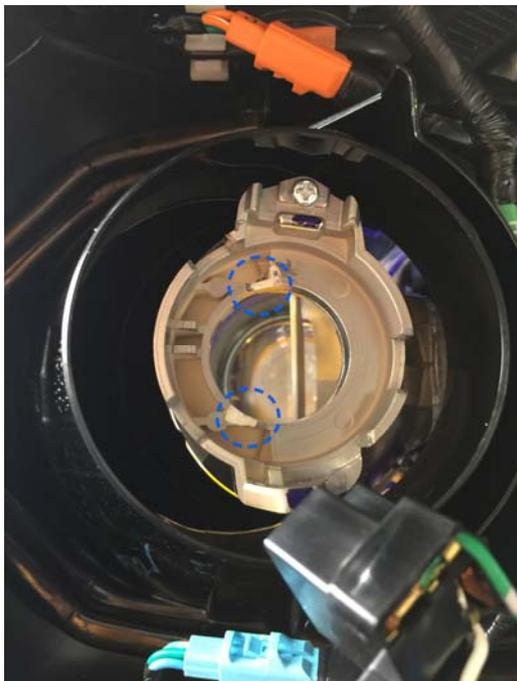
右写真の青色の部分、ソケットホルダーをリューターなどで削り、ソケット取り付け金具との干渉を無くすようにする必要があります。
