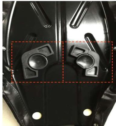
3.画像中の赤マークはパーツが取り付けする部位です。シート後方部分は円柱状のゴムパッドが2ヶ、ボルト止めされます。走行中に緩まないように慣らし走行中は増し締めをしてください。※工場での取り付け済みです。走行前に素手で軽く増し締めを行ってください。
