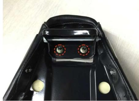
1.画像中の赤マークはパーツが取り付けする部位です。シート後方部分は円柱状のゴムパッドが2ヶ、中央には尖った形状と丸形状の複合形状のパッドが2ヶ、前方にはシートブラケットが装着されます。
