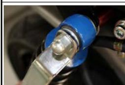
4.ステー、袋ナット(純正部品)の順に取り付けます。リアショックの左右にはワッシャー大(純正部品)が取り付けされていますが、通常はマフラー交換時もそのままにします。フレーム側のネジに十分な突き出し量がなければ、外側のワッシャーは外します。
