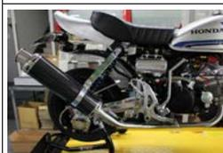
7.マフラー取り付け完了後の画像です。マフラーは一旦各箇所(ネジ)を仮締めした状態を保ち、すべてのパーツを取り付けます。その後、位置が決まった後に本締めを行ってください。
