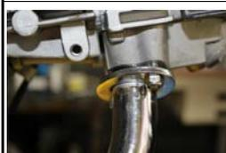
3.シリンダーヘッドナット2ヶを使い、組み立て済みのマフラーAssyをヘッドの排気ポートのスタッドボルト2本へ取り付けます。丸型シリンダーヘッドガスケットをEXパイプとシリンダーヘッドの間に挟み込むように取り付けしてください。
