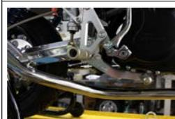
6.EXパイプがバックステップやドラムブレーキペダルの踏み込み時に干渉しないことを確認します。万が一干渉する場合には、サイレンサーステーの変更などで対応してください。
