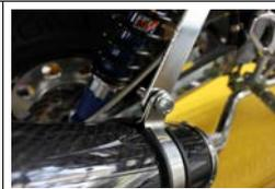
5.サイレンサーバンドの内側へバンドクッションラバー板を取り付けます。次にサイレンサーステーをサイレンサーバンドのφ8穴位置へ合わせ、フランジソケットM8、フランジU付きナットM8で固定してください。この時点では仮締めとします。
