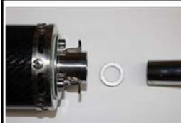
2.サイレンサーは排気口の向き(上下方向)を確認し、EXパイプとサイレンサーをフィッティングスプリング2ヶを使い組み立てます。EXパイプ組み立てメタルガスケットO型は画像のように組み付けます。ガスケットO型が入りにくい場合はペンチなどで押し込みます。
