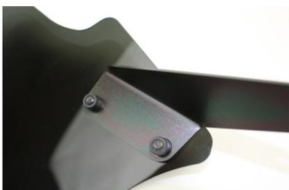
ウェルナットC-550Lはステー表面（この画像はステー裏面の写真です）よりステーにはめ込みます。ウェルナットはネジを締め付けすることで、ゴム部分が膨らみステーに固定される構造です。
