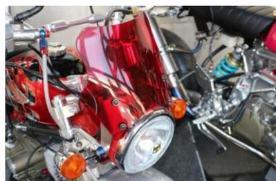
車体への取り付け画像です。カウルステーはヘッドライトステーとヘッドライトの間へ挟むように取り付けしますが、純正フォークはヘッドライトステーの外側へ取り付けしてもかまいません。アルミ製のヘッドライトステーの場合、ステーの厚みがあるため、ヘッドライトステーとヘッドライトの間へ挟むように取り付けします。
