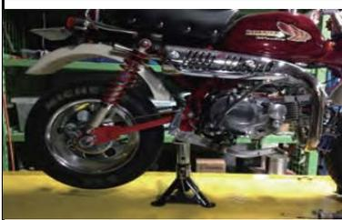
安定感のある場所で後輪をジャッキアップします。この時、バイクが倒れないことを確認します。
