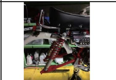
リアショックを取り付けます。リアショック上側はショック内側にM10平ワッシャー大を2ヶ使用、ショック外側は1ヶ使用します。下側はM10平ワッシャーをショックの内側、外側に各1ヶ使用します。下側のM10平ワッシャーは上側のM10平ワッシャー径よりも一回り小さいサイズです。袋ナットの締め付けトルクは2.5~4.0kg/mです。\*各M10平ワッシャーは取り外した純正部品を再利用します。
