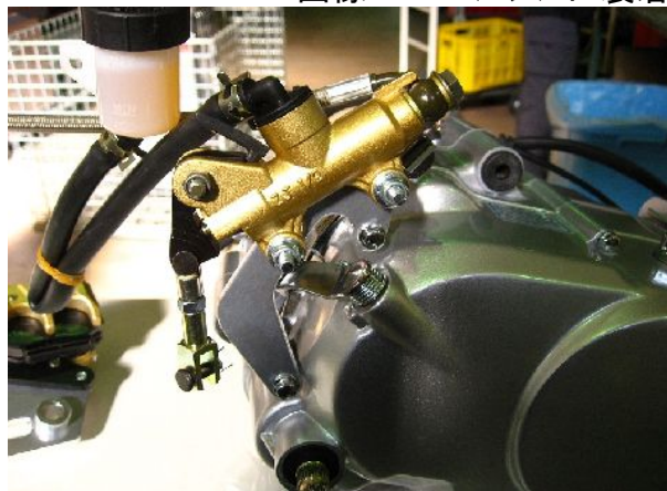
画像10 エンジンに装着されているアウターワイヤーブラケット
